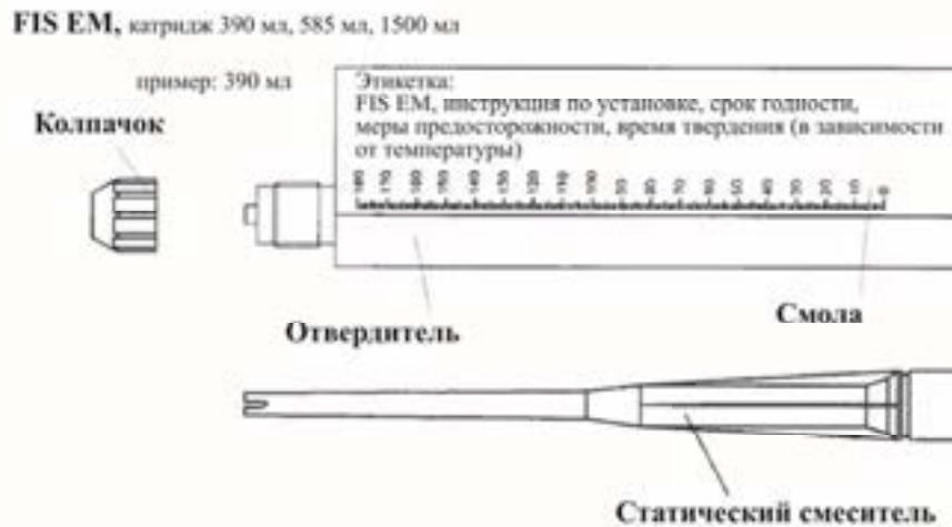
Рисунок 5.1 – Принципиальная схема картриджа с инъекционным составом FIS EM.
